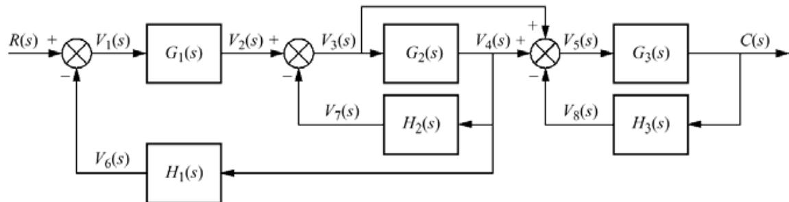
$$\frac{C(s)}{R(s)} = \frac{G_1 G_2 G_3 + G_1 G_3}{1 + G_1 G_2 H_1 + G_2 H_2 + G_3 H_3 + G_1 G_2 G_3 H_1 H_3 + G_2 G_3 H_2 H_3}$$
