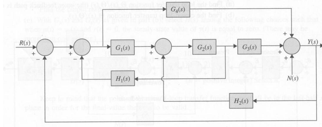
$$Y(s) = \frac{G_1 G_2 G_3 + G_4}{1 + G_1 G_2 G_3 + G_1 G_2 H_1 - G_4 H_2 G_2 H_1 + G_2 G_3 H_2 + G_4} R(s) \\ + \frac{1 + G_1 G_2 H_1}{1 + G_1 G_2 G_3 + G_1 G_2 H_1 - G_4 H_2 G_2 H_1 + G_2 G_3 H_2 + G_4} N(s)$$
